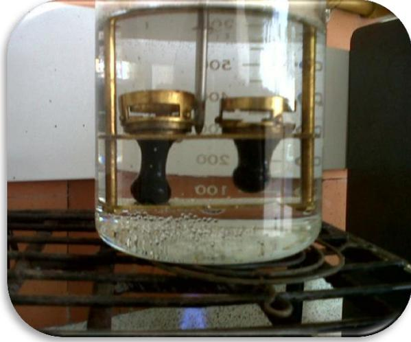
Penetración y Punto de ablandamiento de los materiales bituminosos
