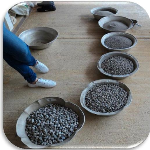
Tamizado de agregados para la dosificación
