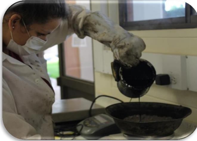
Adición de asfalto al agregado para la preparación de la mezcla
