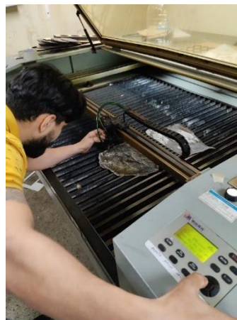
Figura 29. corte laser de laminados flexibles. Autoría propia.
