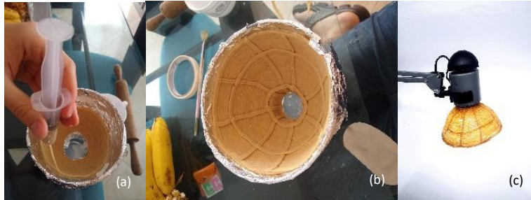
Figura 13. Proceso experimental analógico de impresión 3D. (a)Proceso de vertimiento del material sobre un preforma con ayuda de una jeringa. (b) Estructura interna. (c) Resultado final y aplicación. Autoría propia.
