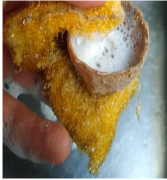
Figura 15. Contenedor bajo prueba de resistencia a lavado abrasivo. Autoría propia.
