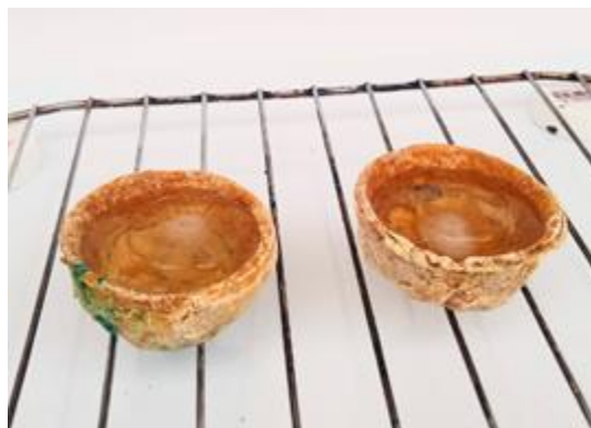
Figura 25. Contenedores de material bajo pruebas de resistencia al agua a 0°C. Autoría propia.
