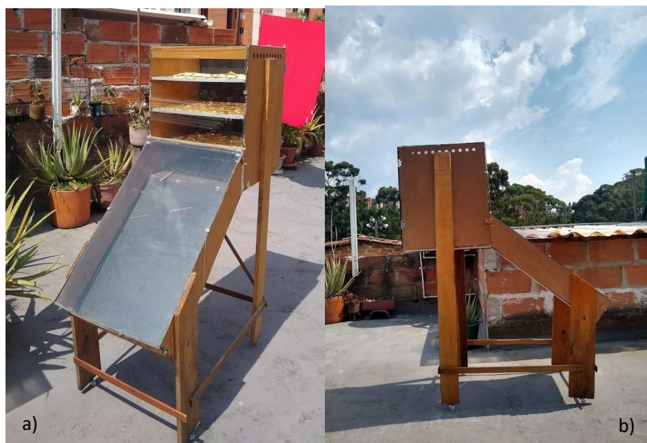
Figura 20. Deshidratador solar desarrollado por el semillero (a) Vista perspectiva b) vista lateral. Autoría propia.
