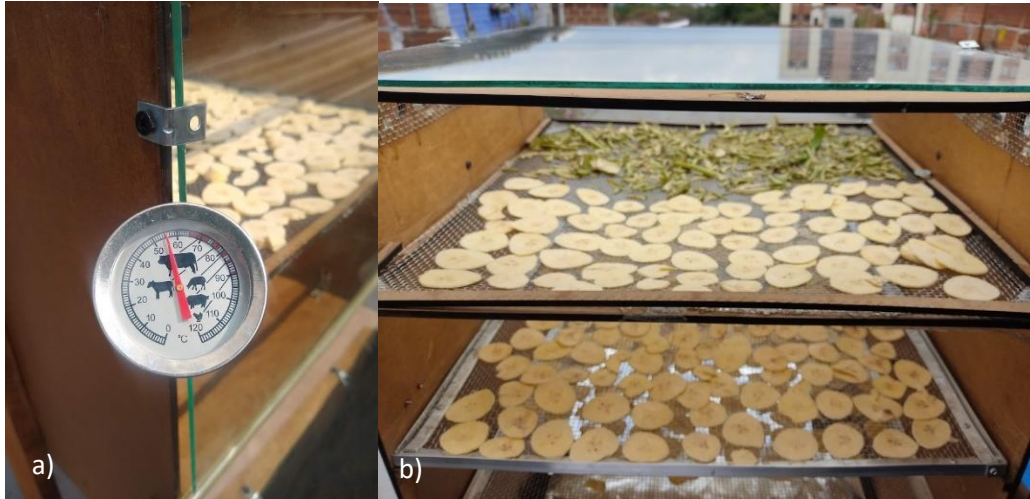
Figura 20. función del deshidratador solar (a) Temperatura interna promedio (b) uso óptimo de las bandejas por niveles. Autoría propia.
