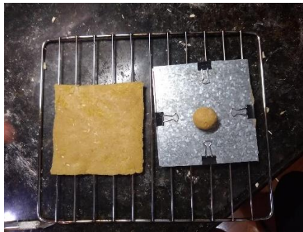
Figura 7. Recopilación fotográfica de resultados, ejemplo de la toma de muestras de laminados y esfera anterior al último secado en horno. Autoría propia.
