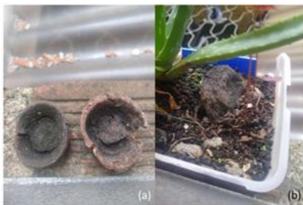
Figura 26. Pruebas de degradación a) Muestras de plátano luego de 3 semanas a intemperie. b) Muestras de plátano luego de 3 semanas a intemperie en terreno orgánico. Autoría propia.
