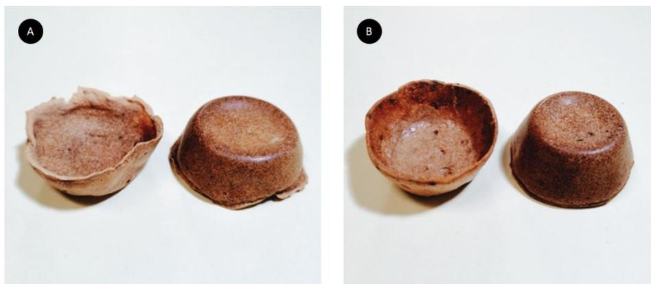
**Figura 29:** Probetas fase A.3. Elaboradas con ñame licuado sin cocción, usando chí y fécula de maíz como aditivos, A) vaciado en molde con contra molde. B) vaciado en molde sin contra molde. Autoría propia.
