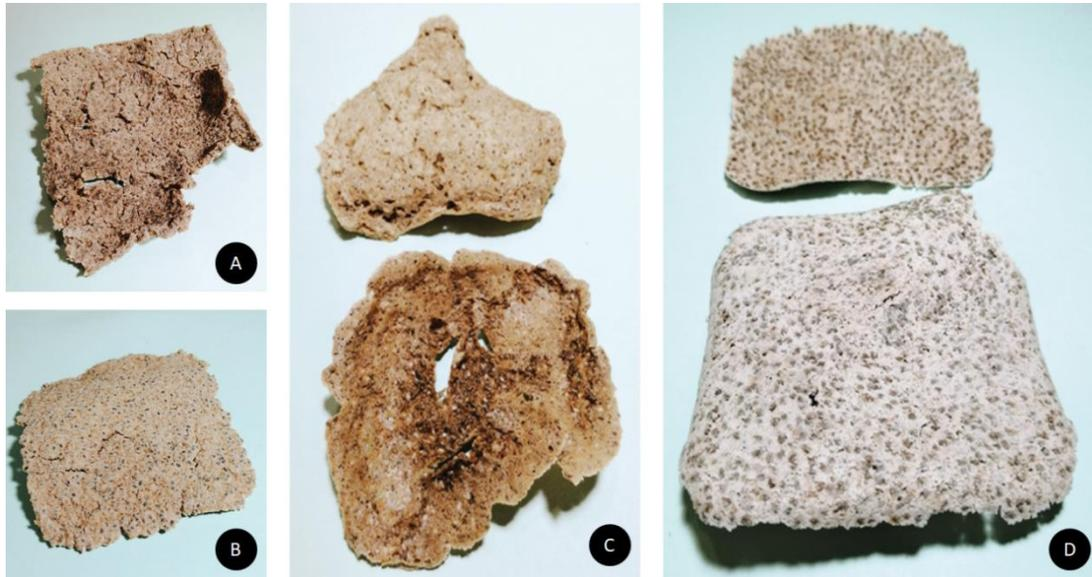
**Figura 25:** Probetas fase A.1, con diferentes tipos de secado, usando chíá como aditivo. A) harina de ñame secado al horno. B) harina de ñame secado al sol. C) ñame crudo secado al horno D) ñame crudo secado al sol. Autoría propia.
