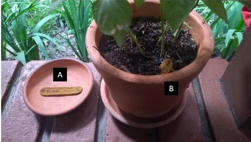
**Figura 16:** Probetas expuestas a la degradación. A) degradación en superficie inorgánica, B) degradación en suelo orgánico. Autoría propia
