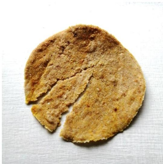
**Figura 53:** Probeta sometida a lavados con agua, esponja y jabón líquido. Autoría propia.
