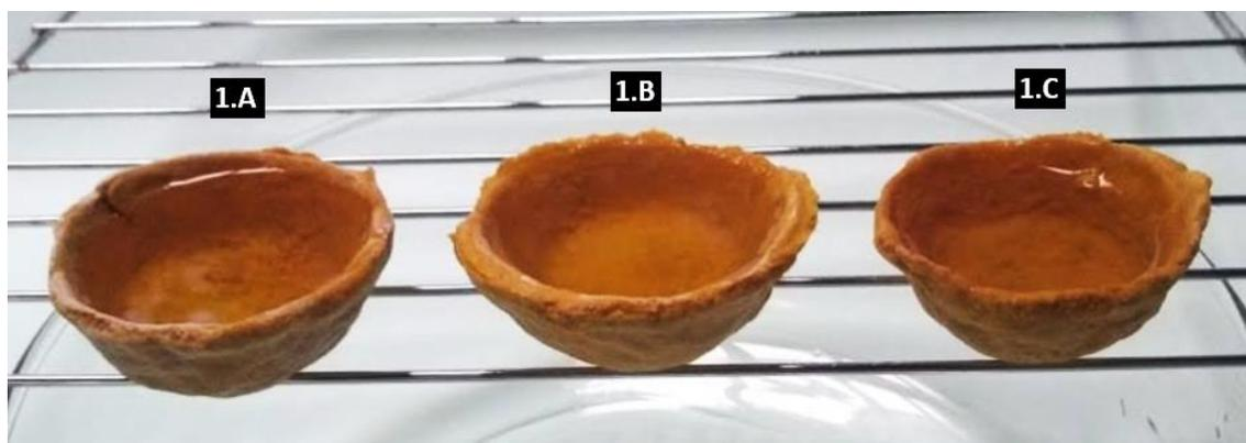
**Figura 14:** Probetas expuestas al contacto directo con el agua. Probeta 1.A contiene agua caliente (60°C), probeta 1.B agua a temperatura ambiente (24°C) y probeta 1.C agua fría (0°C). Autoría propia.
