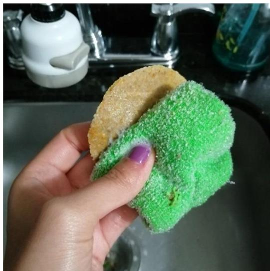
**Figura 15:** Probeta en contacto con agentes abrasivos como la esponja y el jabón de lavar platos. Autoría propia.
