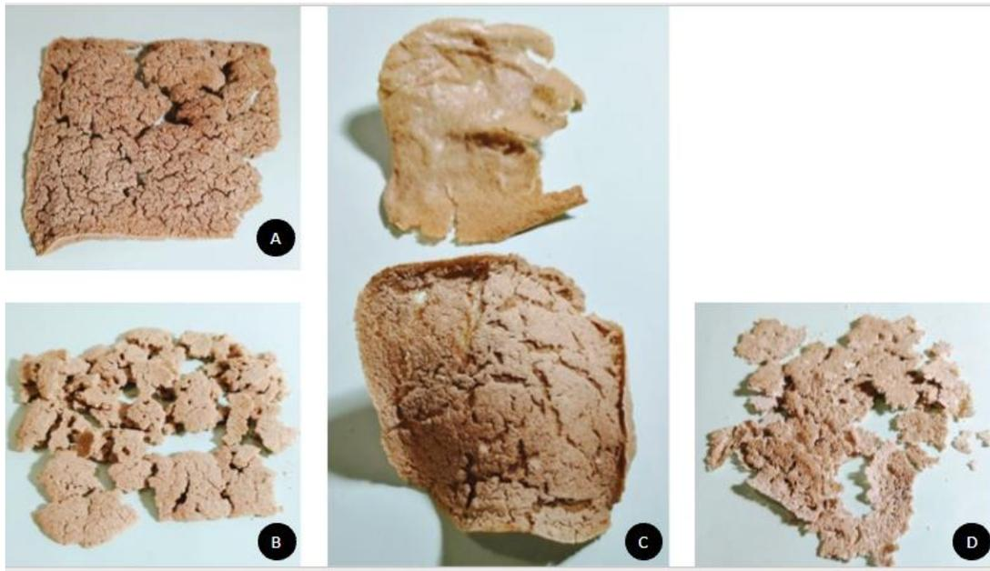
**Figura 27:** Probetas fase A.1, con diferentes tipos de secado, usando CMC como aditivo. A) harina de ñame secado al horno. B) harina de ñame secado al sol. C) ñame sin cocción secado al horno D) ñame sin cocción secado al sol. Autoría propia.
