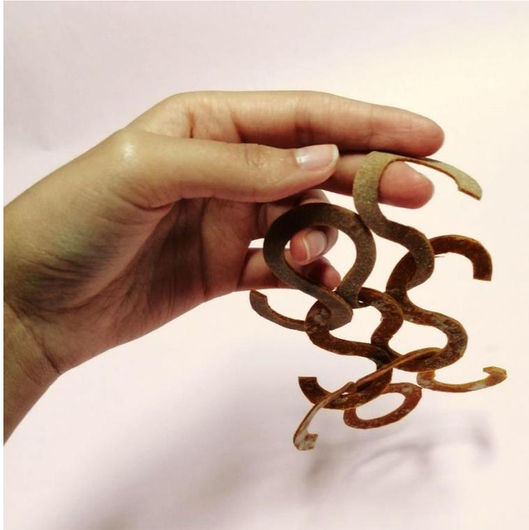
**Figura 61:** Deformaciones en el tejido al no tener una superficie de apoyo. Autoría propia.
