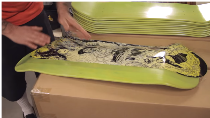
Figura 39. Lámina con diseño gráfico antes de transferir la imagen previa a pasar por el rodillo.
