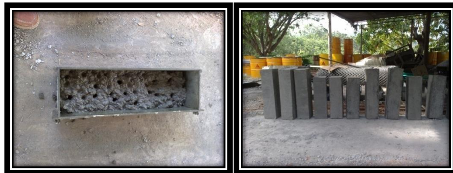
Figura 8. Elaboración de especímenes para ensayos de flexión.
