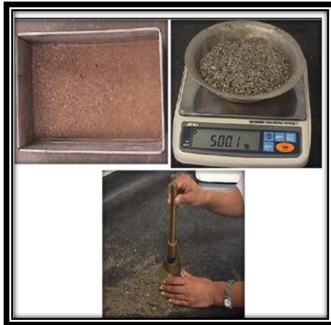
Figura 3. Determinación de la densidad y absorción del agregado fino.
