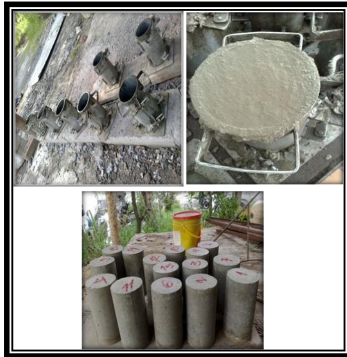
Figura 7. Elaboración de especímenes para ensayos de compresión.
