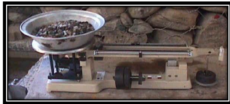
Figura 2. Determinación de la densidad y absorción del agregado grueso.
