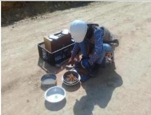
Medición de densidades en primera capa de terraza del talud en suelo reforzado.
