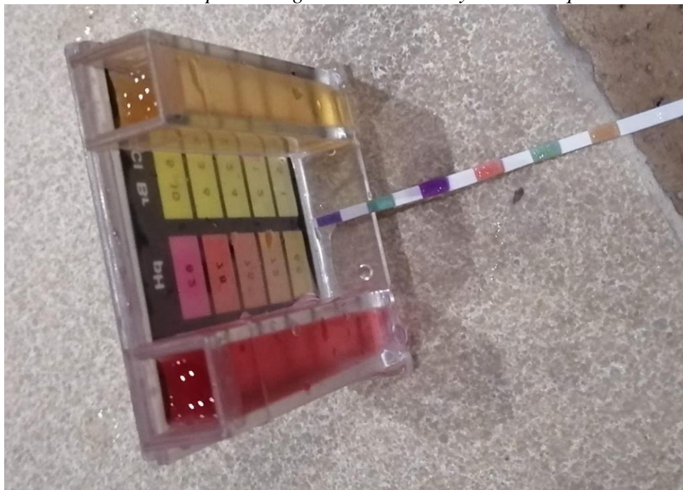
Ilustración 7. Comparación gotas indicadoras y tiras de AquaChek-7
