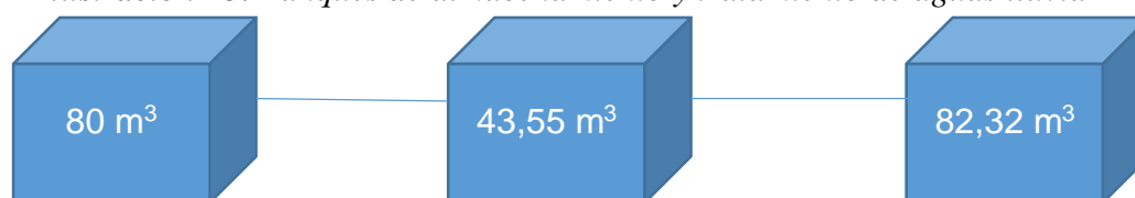
Ilustración 13. Tanques de almacenamiento y tratamiento de aguas lluvia
