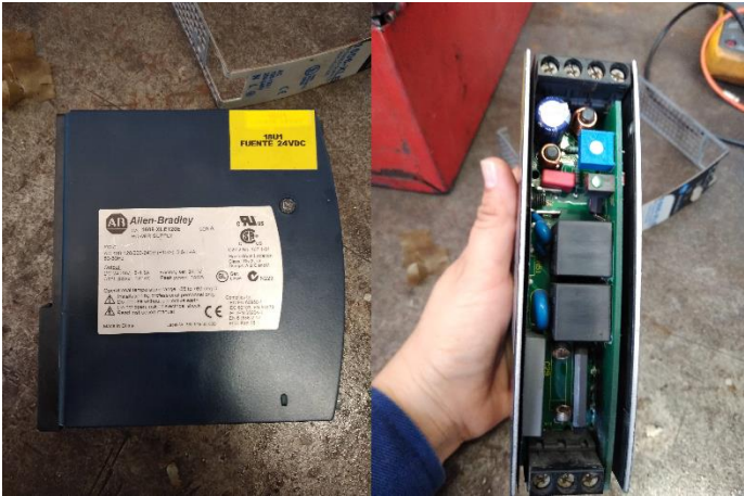
Fuente Allen Bradley 24 de VDC
