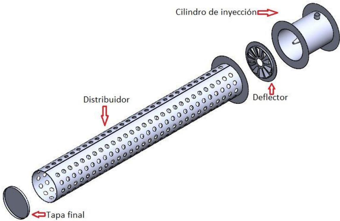
Figura 34 Diseño conceptual de quemador cilíndrico de gas. Fuente: Autoría propia.
