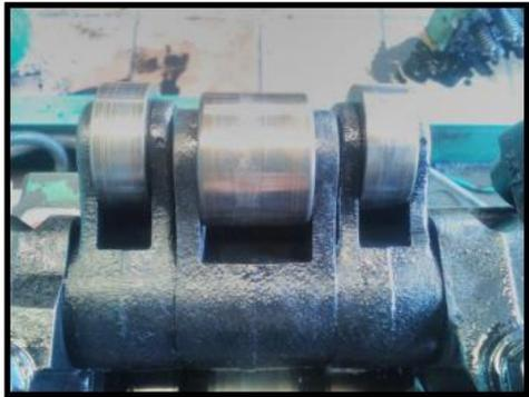
**Fotografía 18.** Rodajas de inyector se encuentran en mal estado con rayaduras, elemento no reparable se debe reemplazar.
