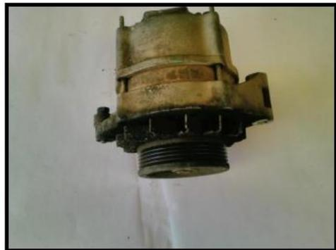
**Fotografía 28.** Se encuentra internamente el alternador muy contaminado con grasa y polvo se debe desarmar y realizar el mantenimiento para evitar a futuro entre en corto circuito.
