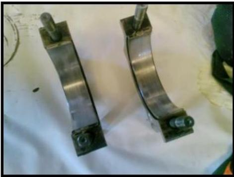
**Fotografía 14.** Casquetes de bancada con desgaste capa protectora no aptos para la reutilización.
