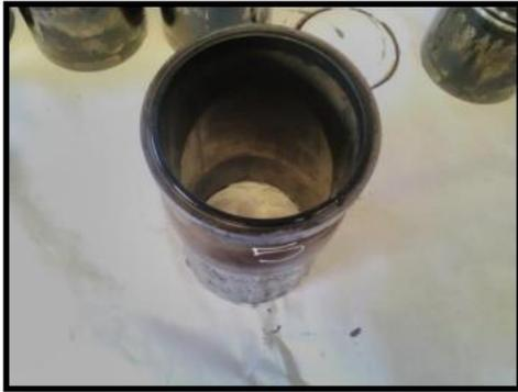
**Fotografía 12.** Camisas de cilindro con desgaste, no son aptas para la reutilización se deben reemplazar para garantizar el buen funcionamiento del motor.
