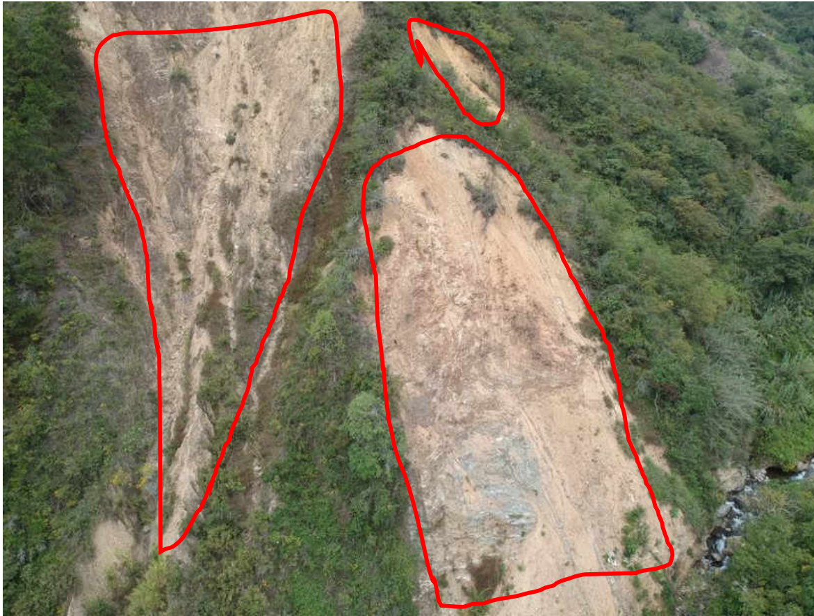
Ilustración 48. K18+500. Zona de montaña con tres deslizamientos críticos.
