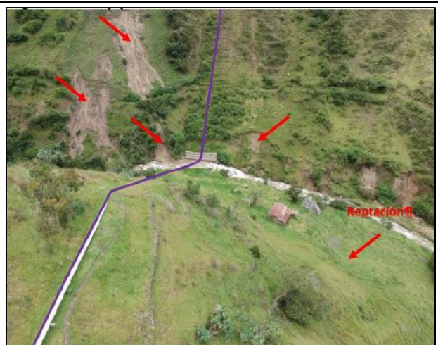
Figura N° 07. DDV y problemas de estabilidad en otros sectores. Fuente: E.D. Ingeotecnia S.A.S.
