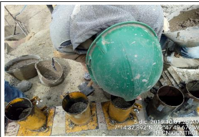
Fotografía N° 19. Toma de ocho (8) muestras de cilindros para ser fallados a la compresión Fuente. Tecnicontrol S.A.S
