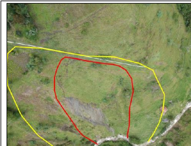
Figura N° 06. Zona de deslizamiento actual (Rojo) y zona muy alta de susceptibilidad geotécnica (Amarillo). Fuente: E.D. Ingeotecnia S.A.S.
