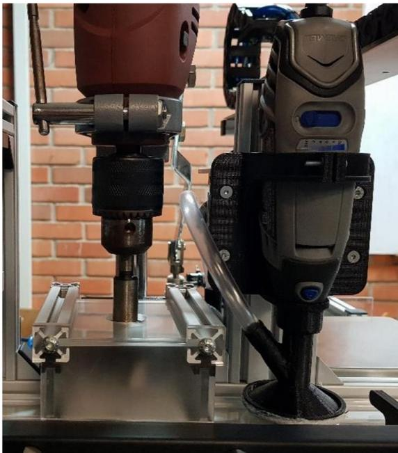
Ilustración 33 Conexión de la aspiradora.
