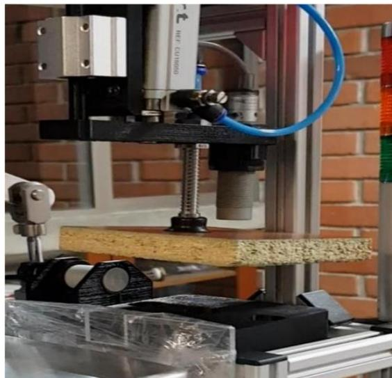
La tabla es llevada hasta la balanza (Ilustración 46) y su masa está en el rango establecido por lo que es depositada en la parte B para las perforaciones (Ilustración 47).
