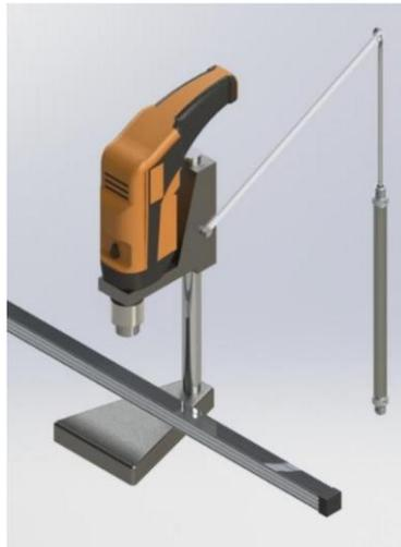
Debido al momento torsor que sufre la madera al ser perforada, es necesario un sistema de prensa como se muestra en la Ilustración 17 que consiste en dos cilindros con vástago de doble efecto A.r.t CI 20010x con 1 cm de carrera para prensar la madera, acoplados a una pieza de 30 cm de longitud para abarcar ambas perforaciones.
