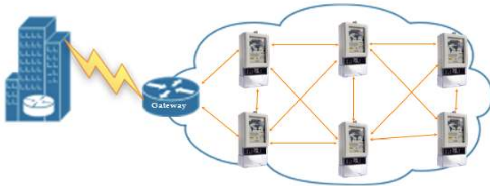
Figura 11. Red en malla utilizada en el proyecto 21
