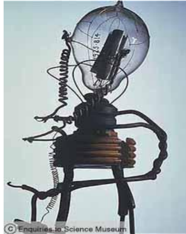
Fig. 14 Válvula creada por Fleming
