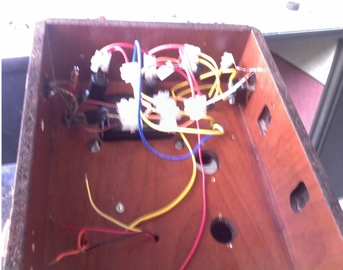
Fig. 52 Construcción del amplificador
