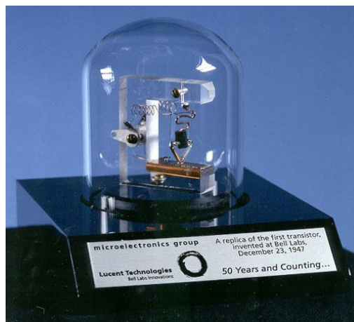
Fig. 3 Replica del primer transistor fabricado
