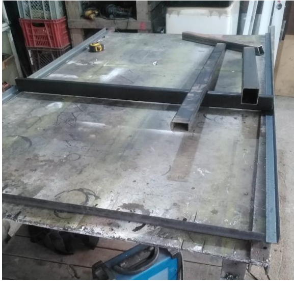
Figura 60. Soporte panel solar. Fuente Autor.
