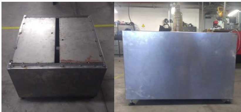
Figura 51. Estructura recubierta con láminas de acero.
