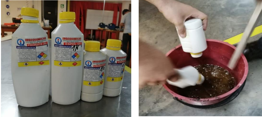
Figura 40. Mezcla componentes para el poliuretano
