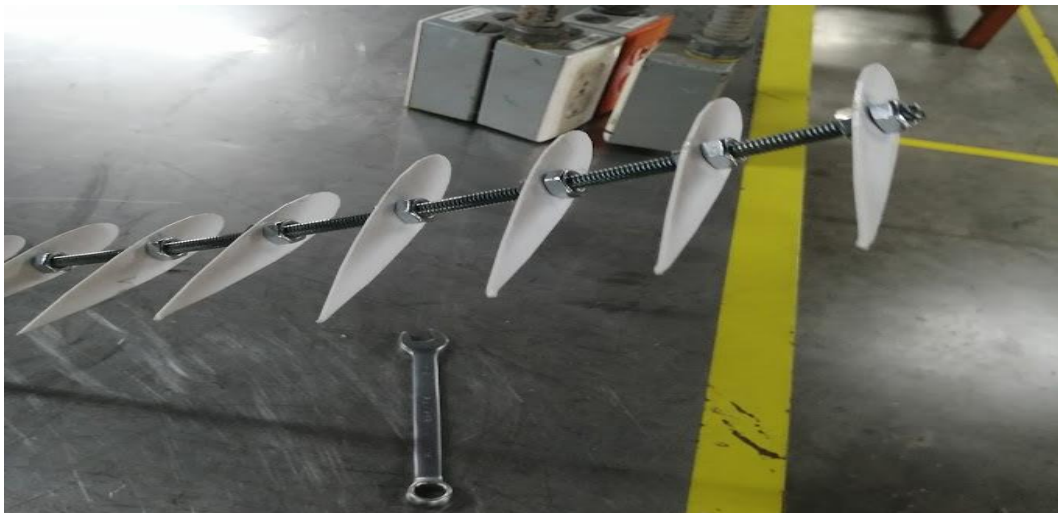
Figura 39. Ensamble de piezas de unión al eje guía
