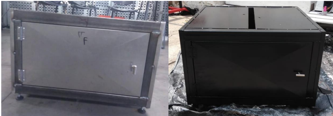
Figura 52. Instalación de puerta y proceso de pintura.
