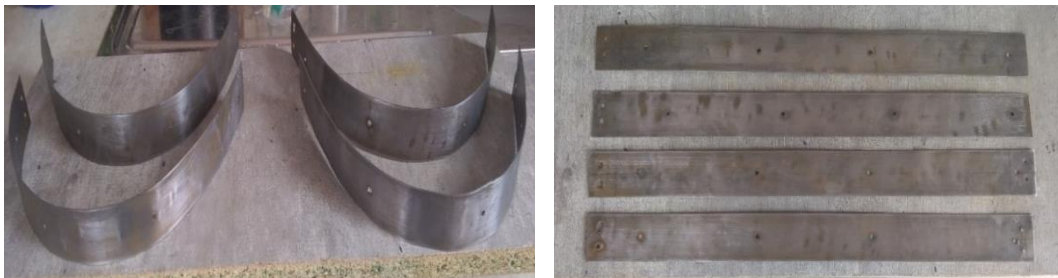
Figura 32. Guías de acero para los álabes.
