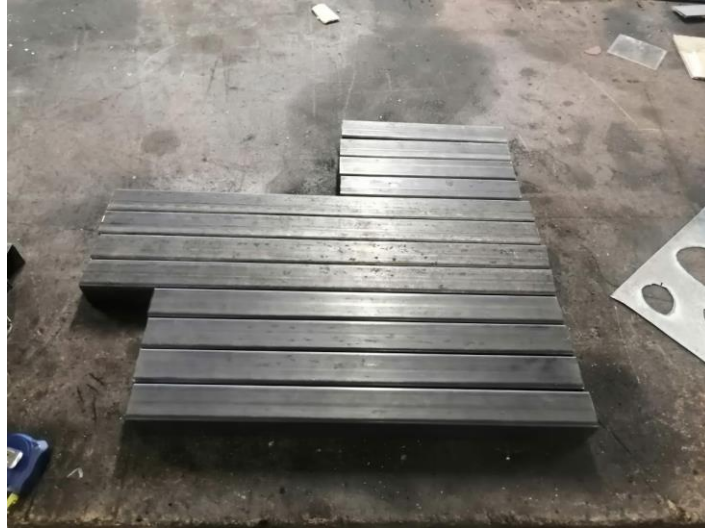
Figura 48. Cortes de perfil para la estructura base.
