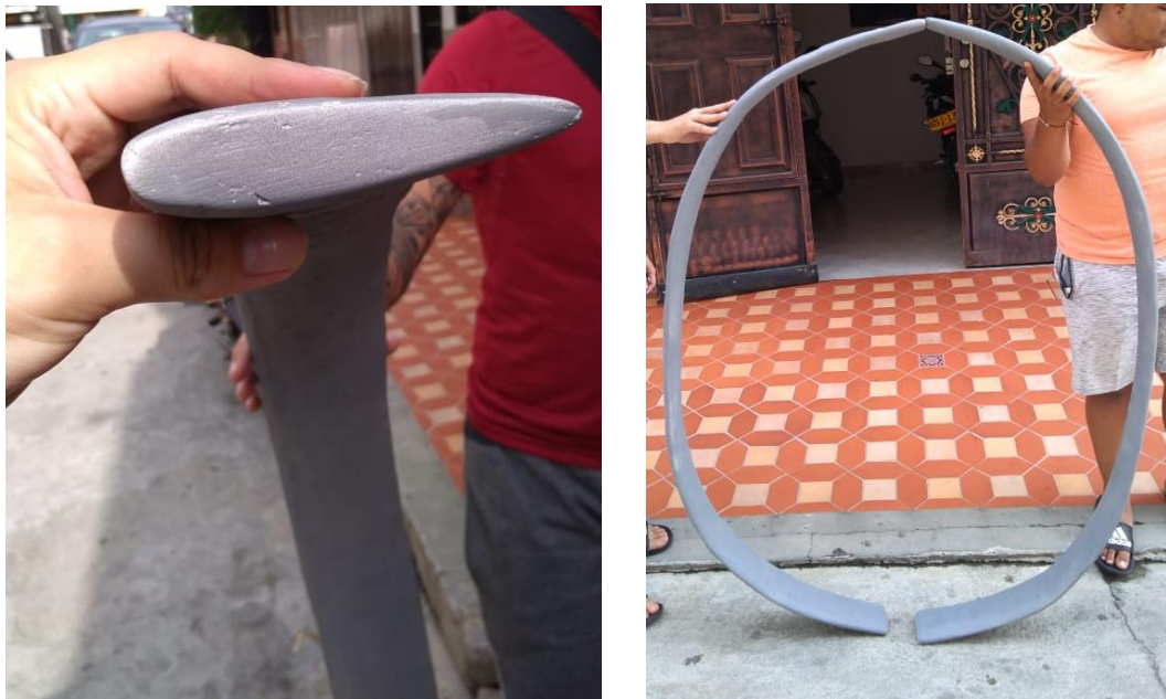
Figura 43. Recubrimiento en fibra de vidrio
