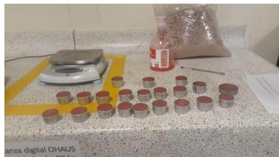
*Imagen 6. Pastillas de suelo después de secado en el horno.*
