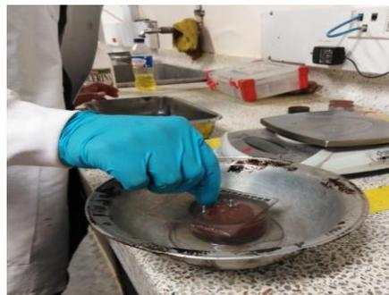
*Imagen 10. Ensayo de límite de contracción utilizando glicerina.*
