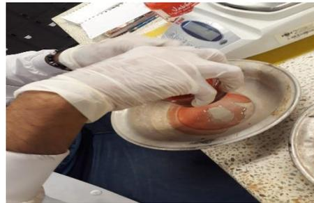
*Imagen 8. Ensayo de límite de contracción utilizando jabón líquido.*
