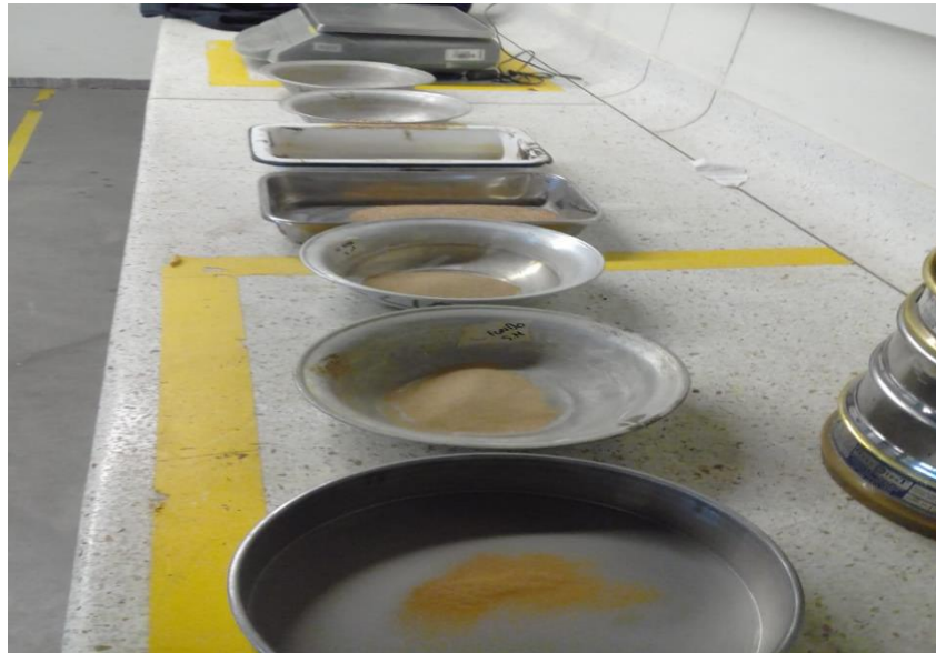
Figura 36. Tamaños de partículas según su tamiz luego de ensayo granulométrico. Fuente: propia
