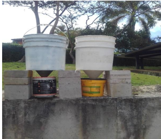
Figura 15. Control peso y riego para el ensayo lisimetro. Fuente: propia
