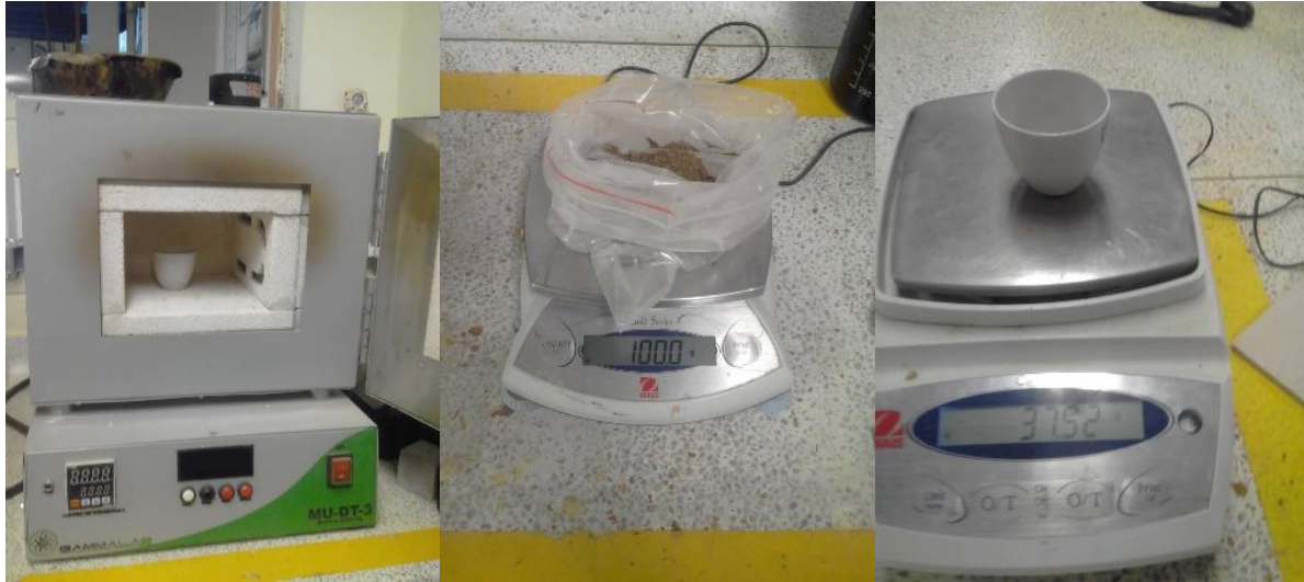
Figura 38. Ensayos de laboratorio – eliminación de humedad y pesaje de la muestra. Fuente: propia.
