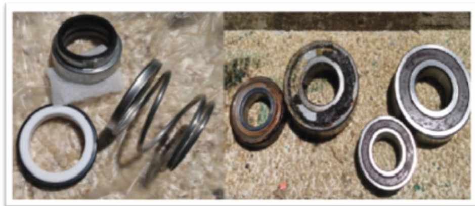
Ilustración 8. Sello mecánico nuevo // Rodamientos desgastados y nuevos.
