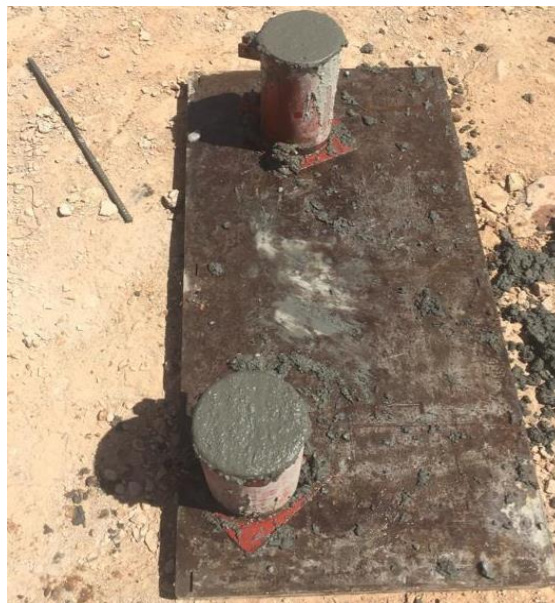
Imagen 31. Toma de Muestras de Concreto
