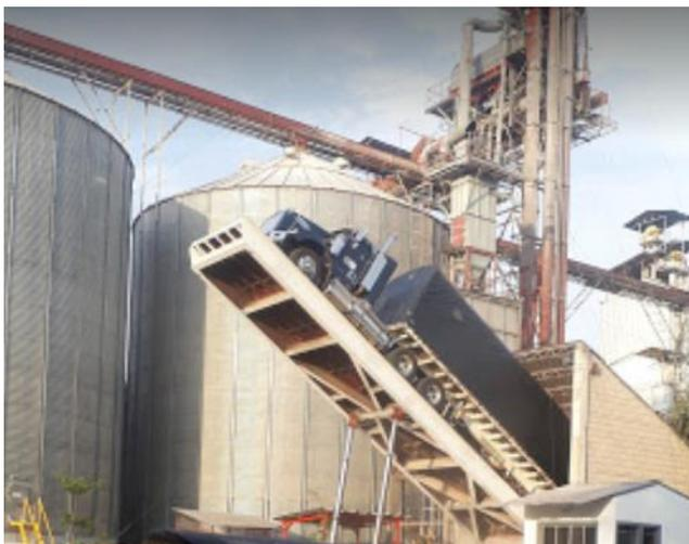
*Figura 2.* Descarga a granel de materia prima
