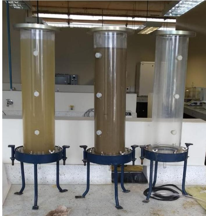
*Figura 4. Columnas de sedimentación.*
