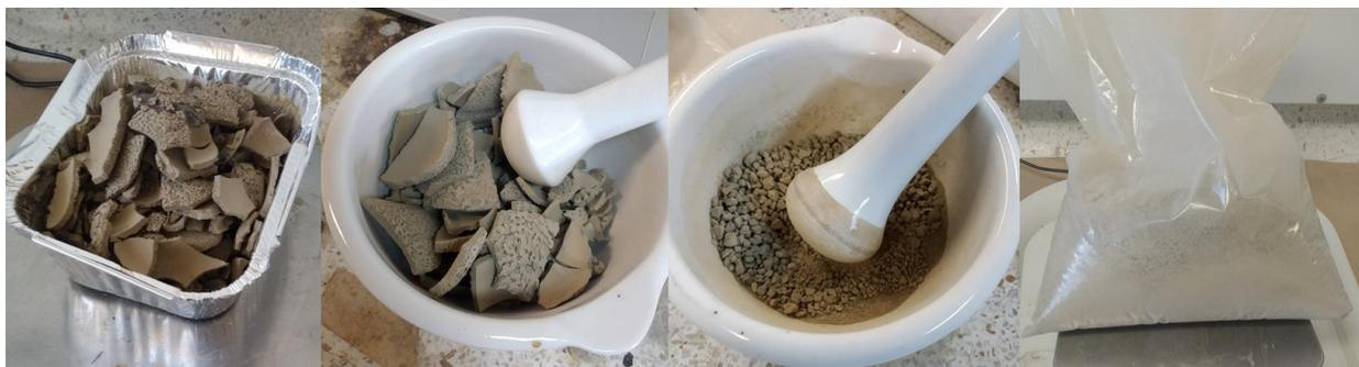
*Figura 5. Preparación de los lodos para uso como aditivo.*
