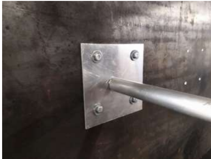
Figura 50. Unión de probeta y placa de empotramiento.
