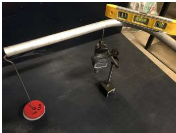
Figura 56. análisis de nivel en base al comportamiento luego de aplicar y retirar una carga.
