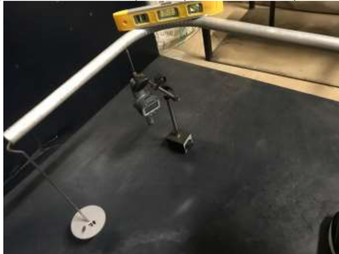
Figura 67. Nivelación de las probetas pre toma de datos experimentales.
