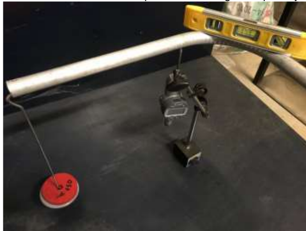
Figura 68. análisis de nivel en base al comportamiento luego de aplicar y retirar una carga.
