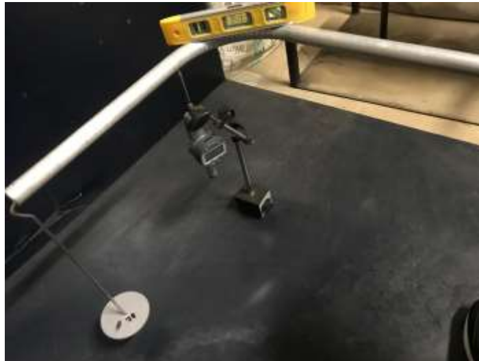
Figura 55: Nivelación de las probetas pre toma de datos experimentales.
