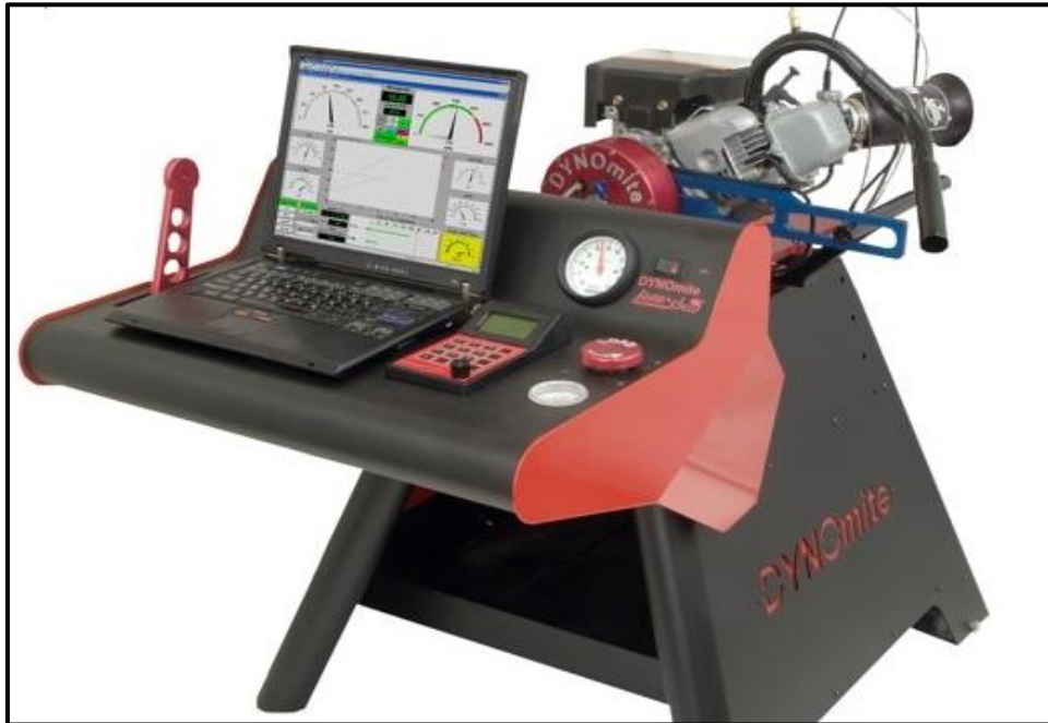
Fig.3.Banco de pruebas kart-Dyno. Fuente: [2]
