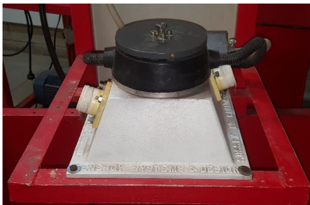
Gráfica 2.6. Turbina turgo empleada en el proyecto.
