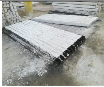
Foto 4. Fraguado de Postes
