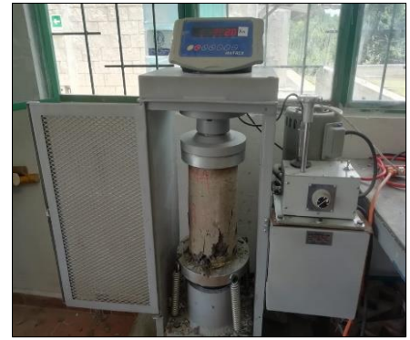
Foto 30. Ensayo a compresion
