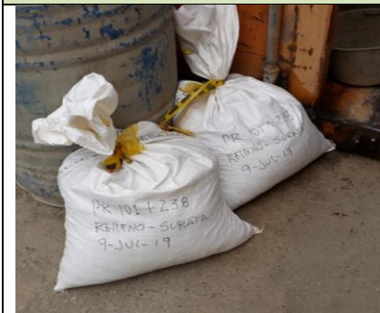
Foto 22. Muestra de relleno utilizado en PR 101+238
