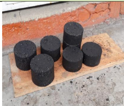
Foto 23. Muestra de Mezcla asfáltica MDC-19 utilizada en PR 104+756
