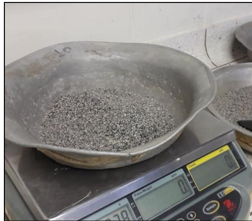
Figura 33. Contenido de agua en agregado fino (Humedad)
