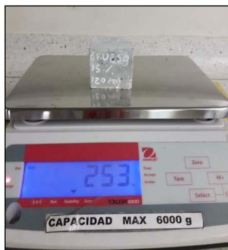
Figura 19. Sustitución de agregado fino por el 15% de hueso de res con 120 ml de agua.
