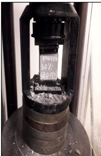
Figura 20. Ensayo preliminar de mortero con sustitución de agregado grueso por el 50% de hueso de res 120 ml de agua.
