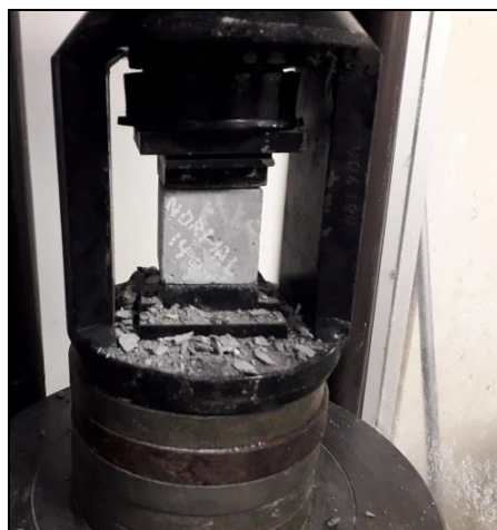
Figura 16. Ensayo preliminar de mortero convencional con 140 ml de agua.
