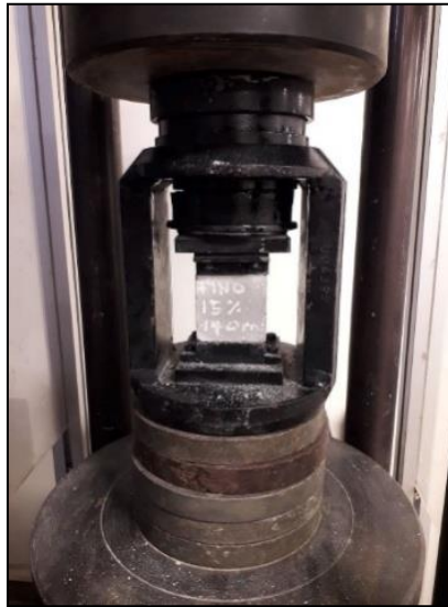
Figura 18. Sustitución de agregado fino por el 50% de hueso de res 190 ml de agua.
