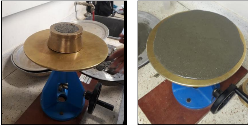
Figura 39. Determinación de la fluidez de morteros de cemento hidráulico
