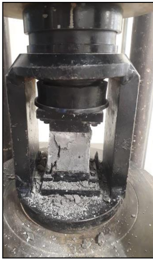
Figura 38. Determinación de la resistencia de morteros de cemento hidráulico.
