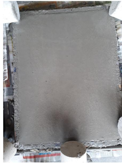
Ilustración 26: Mezcla y panel 40% reemplazo arena Fuente: Propia
