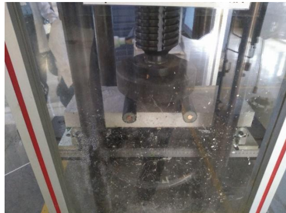
Ilustración 29: Espécimen listo para ensayo a flexión Fuente: Propia
