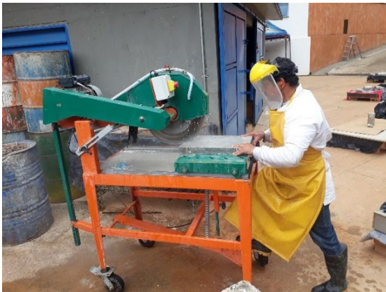
Ilustración 28: Corte de los paneles Fuente: Propia
