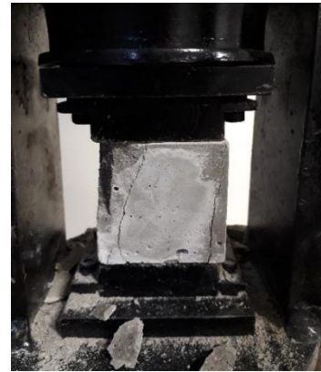
Ilustración 25: Especímenes ensayados a compresión Fuente: Propia
