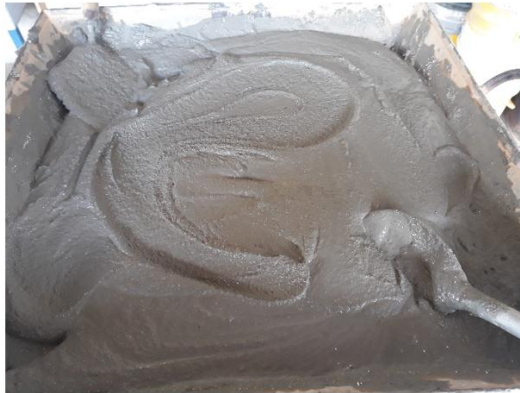
Ilustración 26: Mezcla y panel 40% reemplazo arena Fuente: Propia
