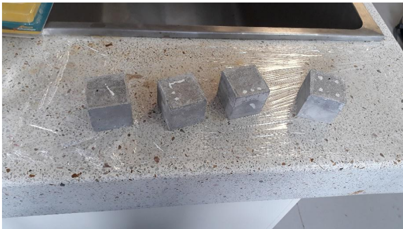
Ilustración 31: Cubos expuestos al ambiente Fuente: Propia
