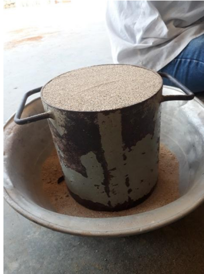
Ilustración 7: Nivelado del molde Fuente: Propia
