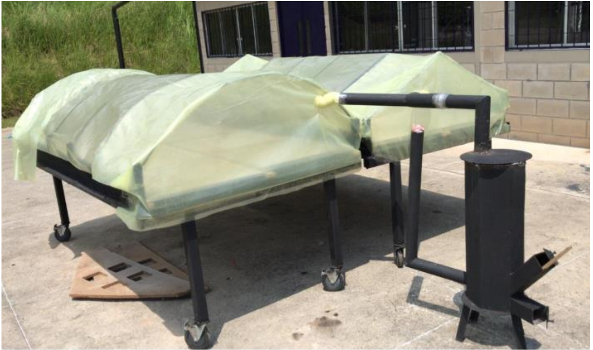
Figura 37. Sistema de calentamiento acoplado.
