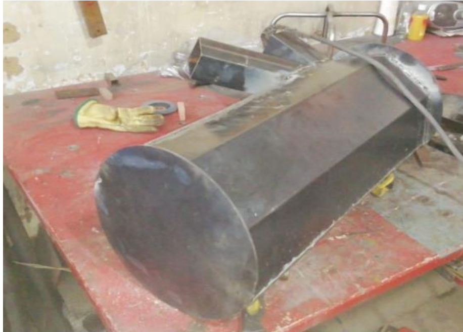
Figura 24. Construcción del quemador .
