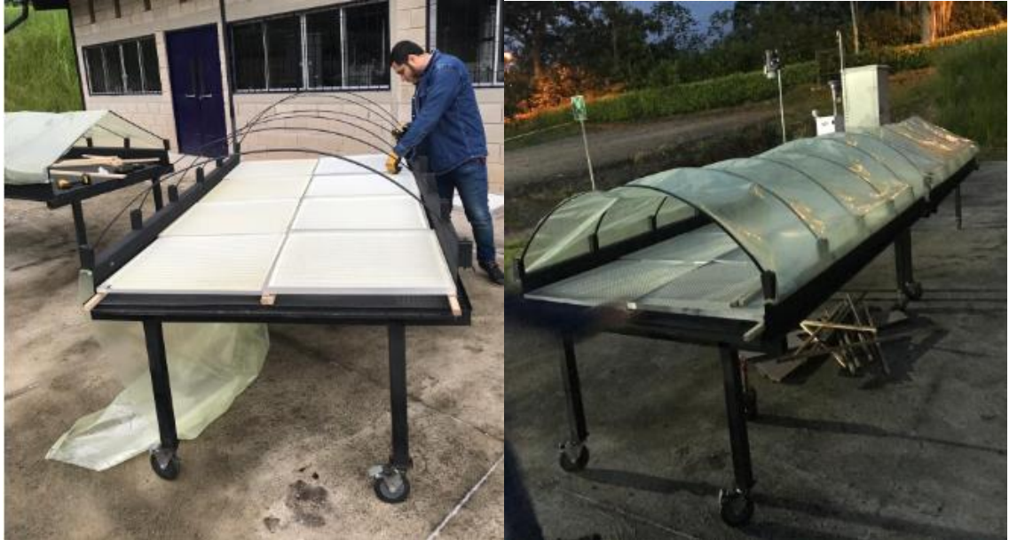
Figura 35. Adecuación de las bandejas y ajuste de barras del túnel de secado.
