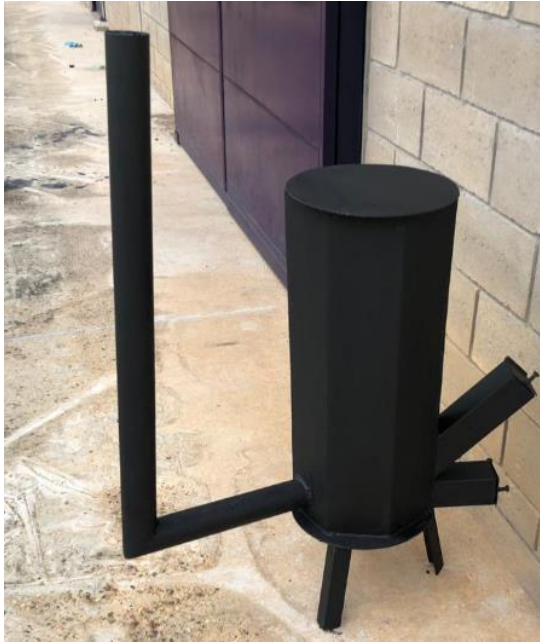
Figura 30. Aplicación de pintura anticorrosiva.
