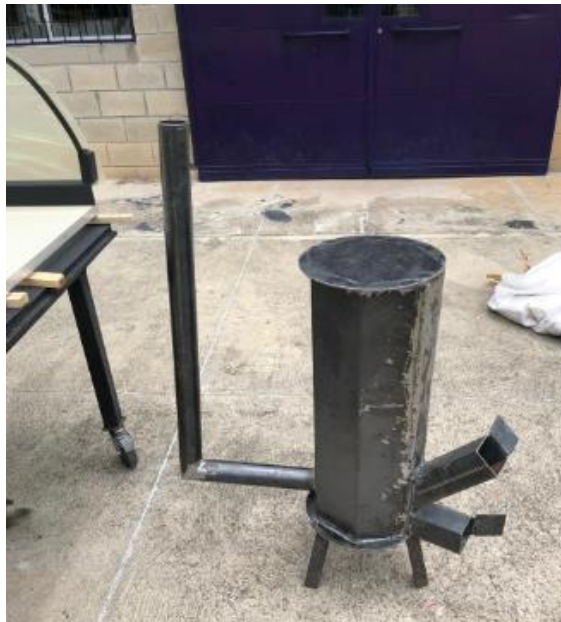
Figura 28. Quemador acoplado con sus partes sin accesorios.
