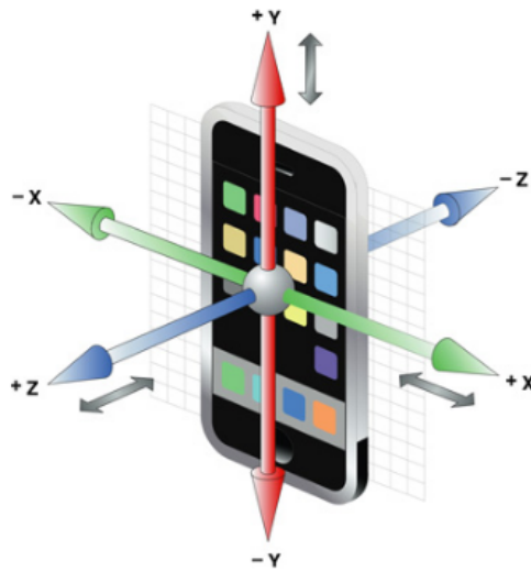
Figura 2: Ejes de medición de un acelerómetro en un teléfono inteligente. Imagen tomada de 2
