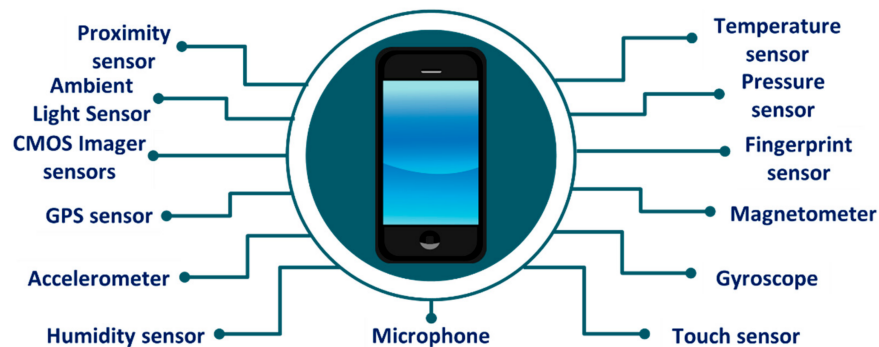
Figura 1: Sensores encontrados en un teléfono celular inteligente. Imagen tomada de 1
