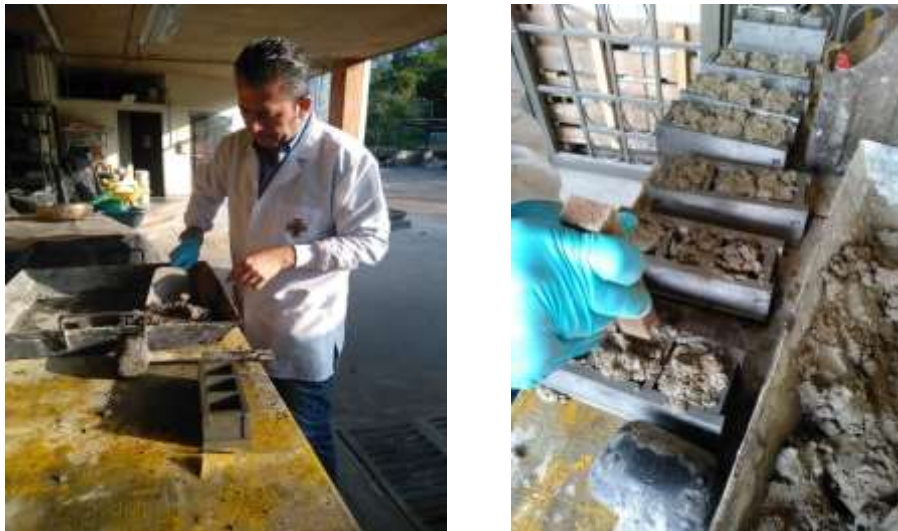
Figura 28. Elaboración de especímenes
