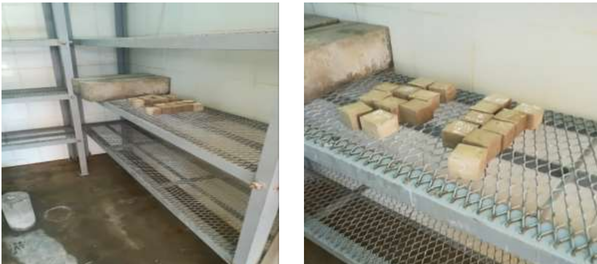
Figura 29. Curado de especímenes
