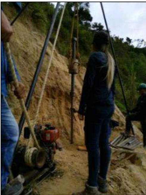
Fotografía 26. Avance en actividades de perforación con equipo SPT
