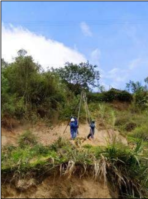
Fotografía 26. Avance en actividades de perforación con equipo SPT
