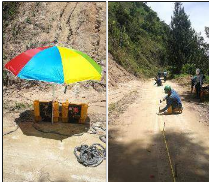
Fotografía 13. Adquisición en campo de la tomografía de resistividad eléctrica PN-1.
