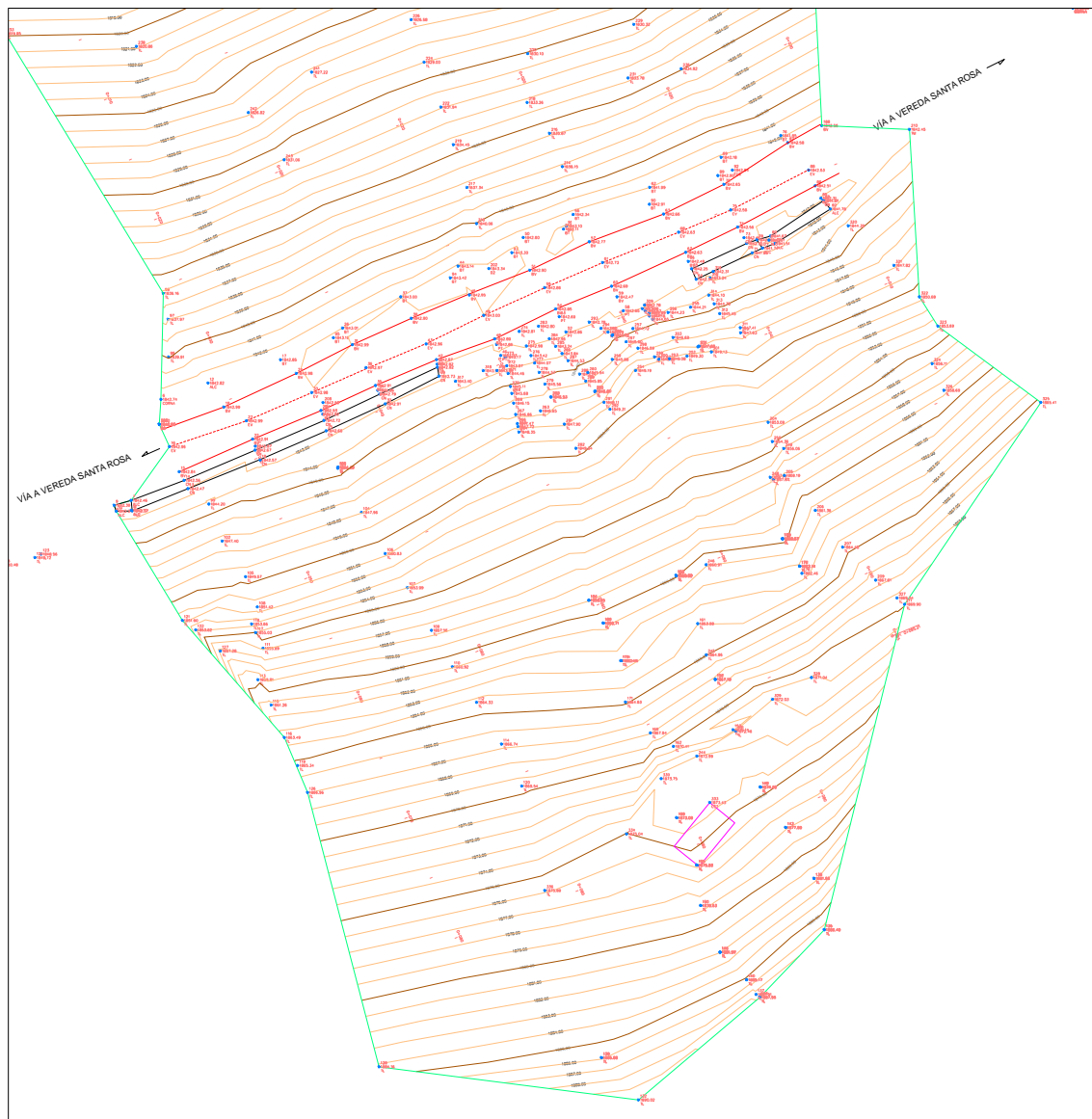
Figura 6. Levantamiento topográfico deslizamiento Vía Vereda Pozo Negro.
