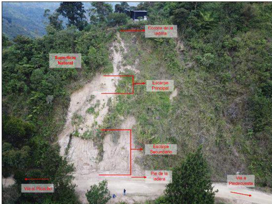
Fotografía 4. Vista frontal del sitio de estudio y definición de partes de un deslizamiento.
