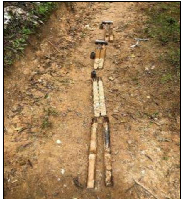
Fotografía 23. Registro del sondeo 1 – evidencia de todas las muestras perforadas
