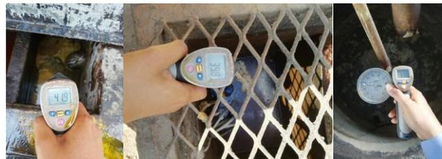
*Ilustración 40. Seguimiento y control de temperatura a cajas del sistema DAF*
