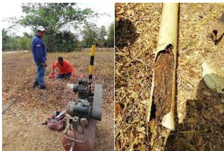
*Ilustración 42. Taponamiento de tubería con grasa cristalizada.*
