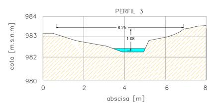
Figura 65 Sección batimétrica Perfil 3
