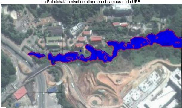
Figura 46 Modelo de inundaciones mediante el software FLO-2D para un TR-20 años en la quebrada La Palmichala a nivel detallado en el campus de la UPB.
