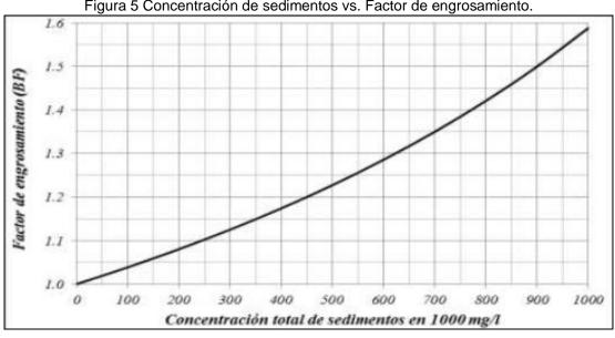
Figura 5 Concentración de sedimentos vs. Factor de engrosamiento.
