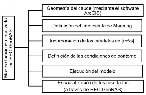
Figura 35 Metodología para la ejecución del modelo hidráulico por HEC-GeoRAS.
