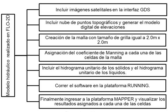
Figura 39 Metodología para la ejecución del modelo hidráulico por FLO-2D.
