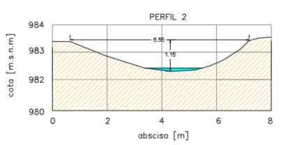
Figura 64 Sección batimétrica Perfil 2
