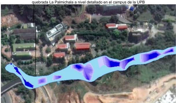
Figura 48 Modelo de inundaciones mediante el software HEC-GeoRAS para un TR-50 años en la quebrada La Palmichala a nivel detallado en el campus de la UPB
