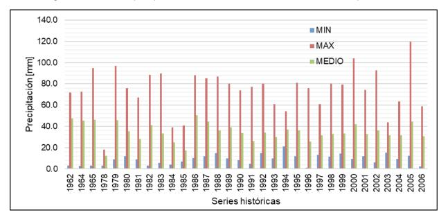
Figura 13 Valores de precipitación máxima en 24 horas de la estación La Esperanza.
