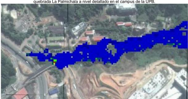
Figura 52 Modelo de inundaciones mediante el software FLO-2D para un TR-100 años en la quebrada La Palmichala a nivel detallado en el campus de la UPB.
