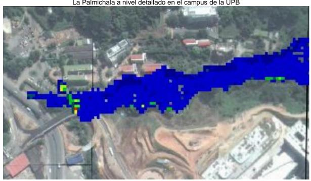
Figura 58 Modelo de inundaciones mediante el software FLO2D para un TR-500 años en la quebrada La Palmichala a nivel detallado en el campus de la UPB
