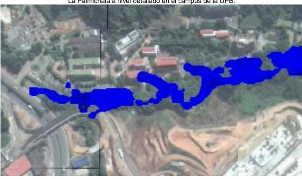
Figura 49 Modelo de inundaciones mediante el software FLO-2D para un TR-50 años en la quebrada La Palmichala a nivel detallado en el campus de la UPB.
