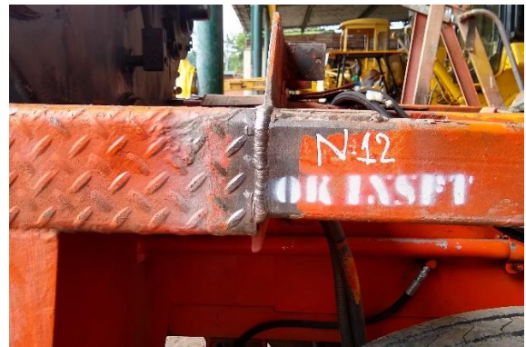
Fisura corregida por soldador Fisura chasis – parte soporte de motor #1 derecha
