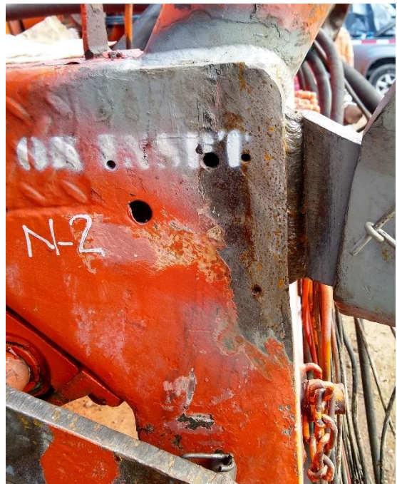
Fisura corregida por soldador
