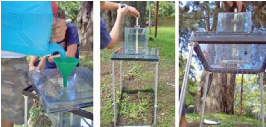
Figura 7. Simulador de lluvia por goteo.
