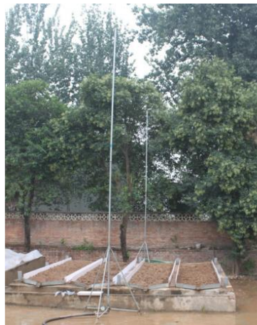
Figura 8. Simulador de lluvia por aspersión.
