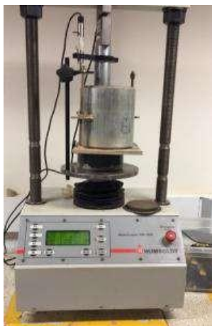
Fotografía 13. Equipo para el ensayo de CBR Fuente: Elaboración propia
