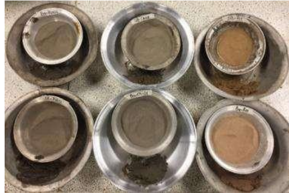
Fotografía 7. Muestras para el ensayo de límite líquido y plástico Fuente: Elaboración propia
