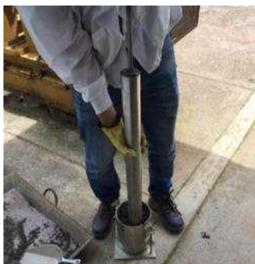
Fotografía 11. Proceso de compactación manual Fuente: Elaboración propia
