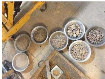
Fotografía 5. Porciones del material retenido en cada tamiz Fuente: Elaboración propia
