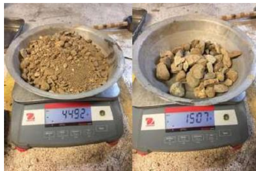
Fotografía 9. Muestra separada por el tamiz \frac{3}{4} Fuente: Elaboración propia
