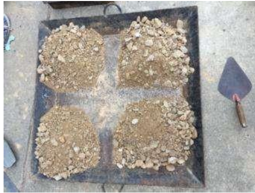
Fotografía 1. Cuarteo del material para granulometría
