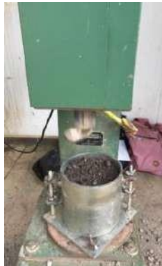
Fotografía 10. Proceso de compactación mecánico Fuente: Elaboración propia
