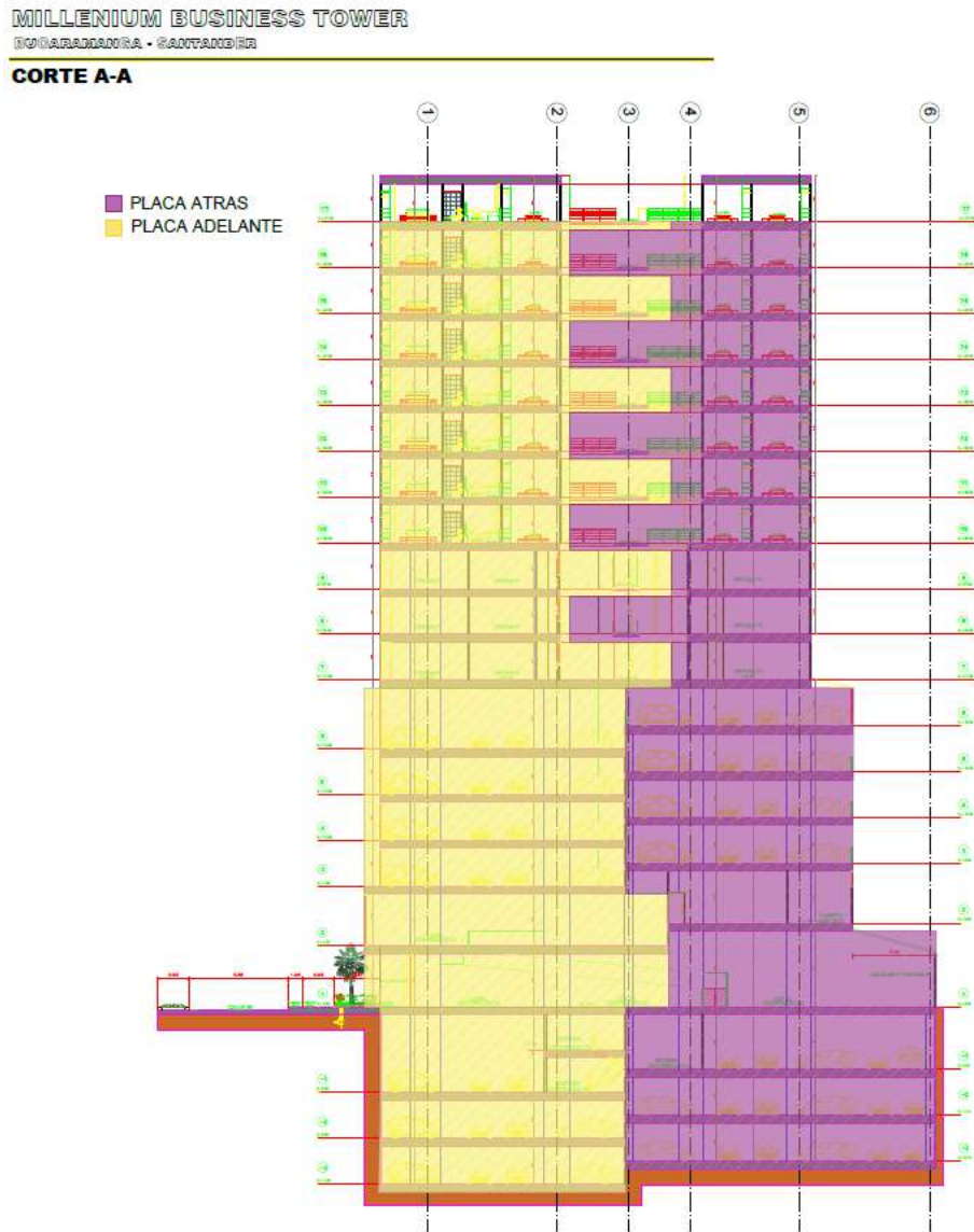
Figura 6-6. Corte A-A con divisiones de placa
