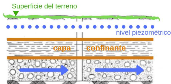
Figura 3. Esquema de un acuífero confinado (Vélez, 2011).
