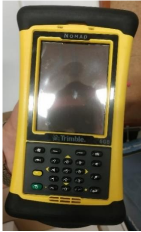
Figura 10 Imagen del GPS marca Trimble utilizado para la recolección de los puntos x,y,z de cada pozo.
