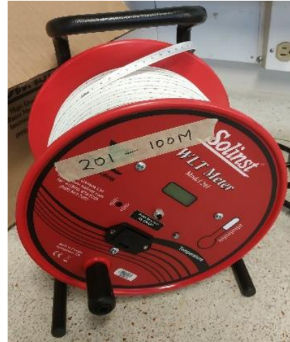
Figura 11. Imagen del equipo Solinst Water Level Meter, modelo 101 utilizado para la recolección de información de profundidad del nivel del agua subterránea.
