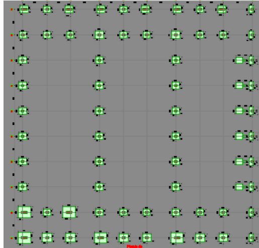
Imagen 30 Localización de Zapatas en el terreno.
