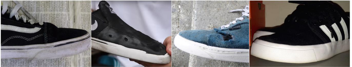
Imagen 84. Desgaste bumper. Prueba durabilidad con usuario.
