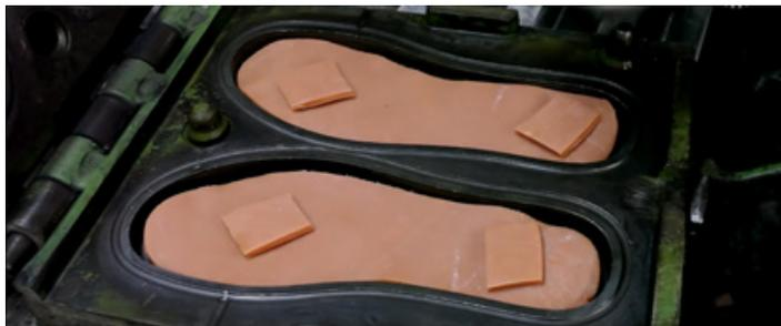
Imagen 11. Moldeado de caucho por calor y presión para formar la suela Vans (Vans, 2016).
