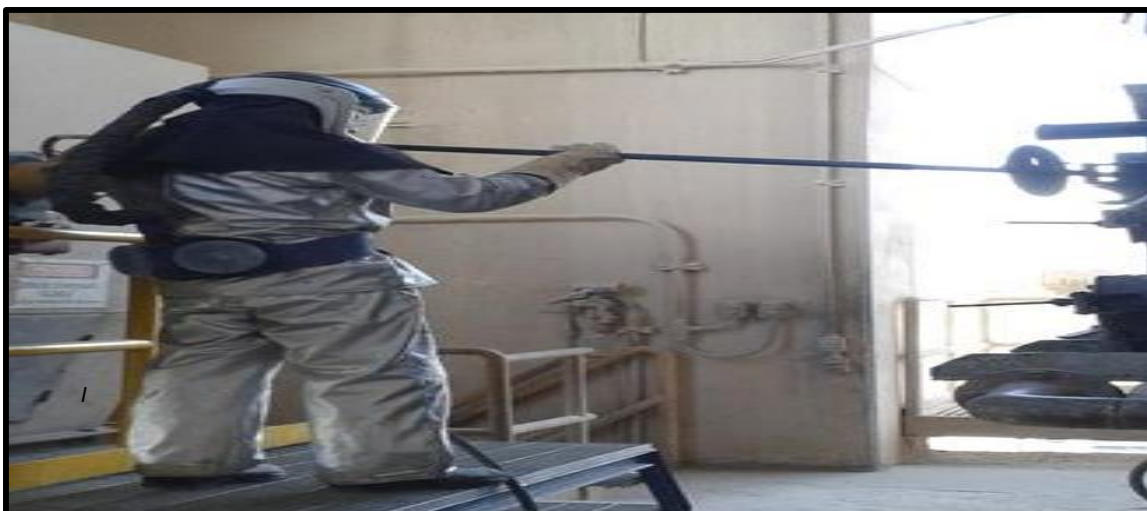
Ilustración 10. Limpieza de piqueras con traje aluminizado
