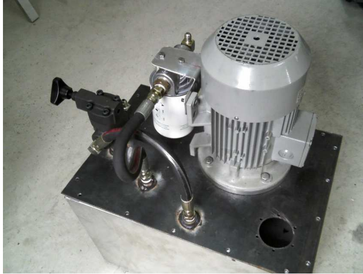
Ilustración 5. Tanque de depósito de fluido hidráulico. Fuente: Autores del proyecto.
