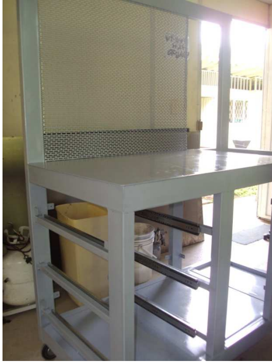
Ilustración 3. Estructura pintada con los rieles para los cajones. Fuente: Autores del proyecto.
