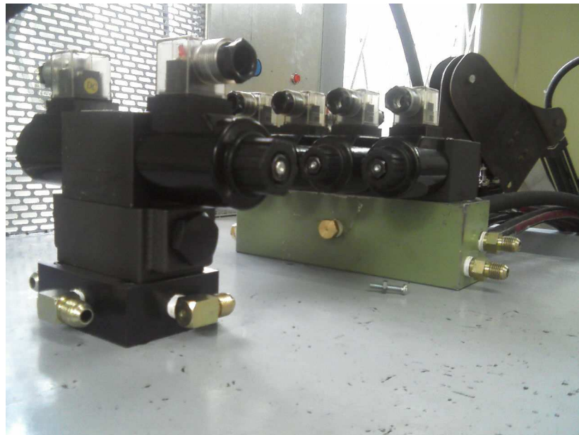
Ilustración 8. Electroválvulas y distribuidores. Fuente: Autores del proyecto.
