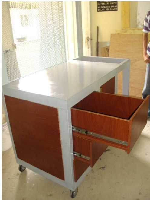
Ilustración 4. Cajones instalados. Fuente: Autores del proyecto.
