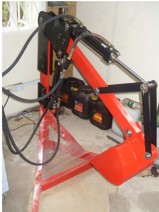
Ilustración 14. Brazo hidráulico terminado. Fuente: Autores del proyecto.
