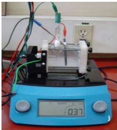
Fig. 1. Montaje para realizar las pruebas electroquímicas
