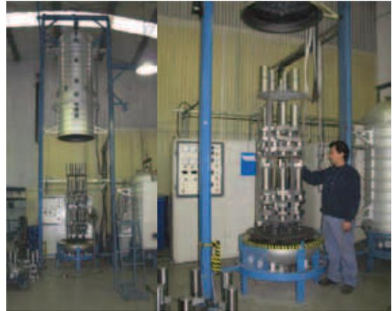
Fig. 3. Equipo vertical de nitruración iónica, puede verse una carga típica
