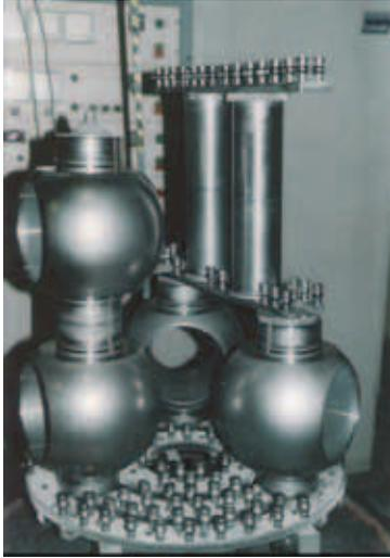
Fig. 5. Válvulas esféricas (diámetro máximo 350 mm) fabricadas en acero inoxidable tipo AISI 316L
