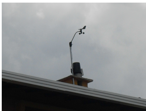
Foto 02. Vista de la estación sobre la chimenea a 10 metros de altura.
