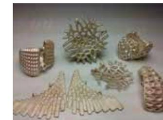
Figura 11: Piezas fundidas obtenidas en el proceso de microfundición.
