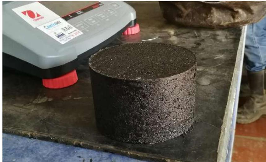
*Imagen 45. Briquetas para ensayos de calidad.*
