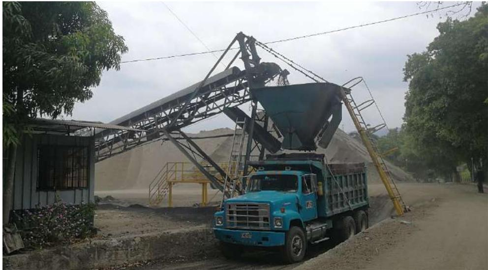
*Imagen 43. Descargue de mezcla sobre volquetas.*
