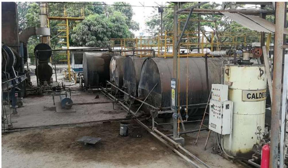
*Imagen 39. Caldera y tanques de almacenamiento de asfalto planta Tecnopavimentos.*
