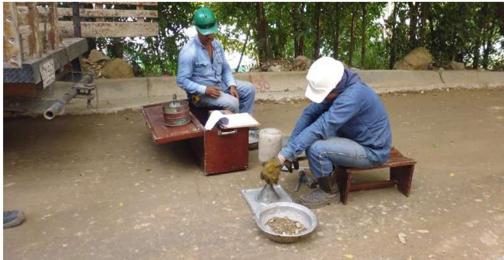
*Imagen 36. Ensayo de campo "Cono de arena".*
