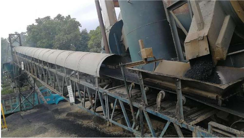
*Imagen 42. Salida de mezcla asfáltica a banda transportadora.*
