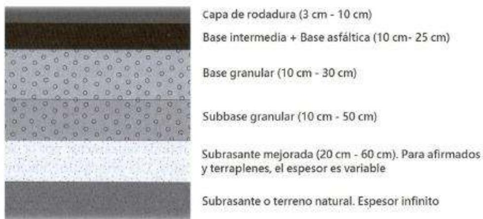
Figura 2. Perfil típico de una estructura de pavimento flexible.
