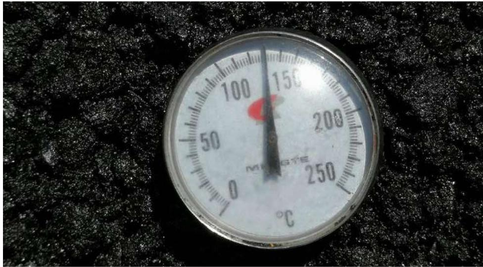
*Imagen 35. Temperatura de llegada de mezcla asfáltica.*
