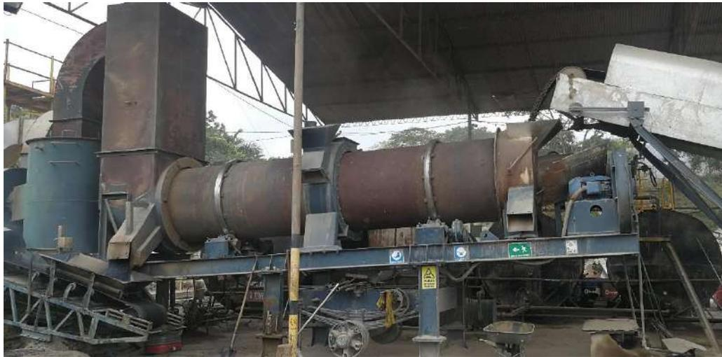
*Imagen 41. Tambor calentador-mezclador planta Tecnopavimentos.*
