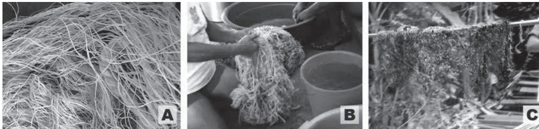
Figura 3: A. Ramas desfibradas y organizadas en montículos para el lavado; B. Lavado manual de las fibras con agua y limón; C. Secado de las fibras al sol (fuente de los autores).
