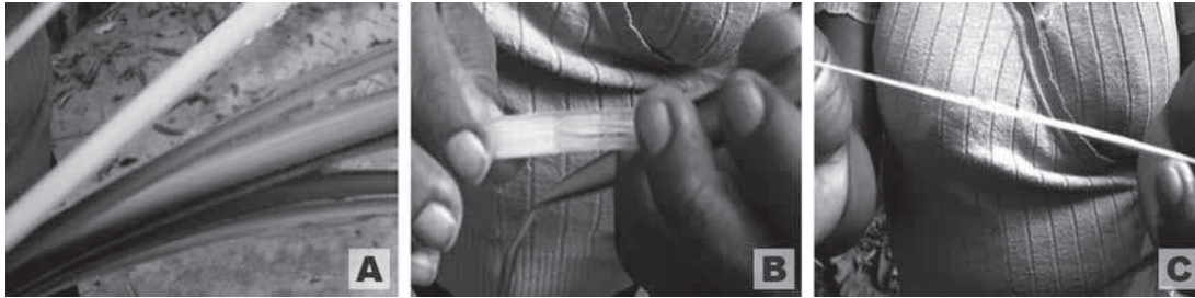
Figura 2: A. Pequeña cantidad de ramas seleccionadas para proceder con la producción del hilado; B. Proceso de hilatura hecho con una de las ramas seleccionadas; C. Ejemplo de un hilo producido a partir de las ramas de tucumã-i ( Astrocaryum acaule ) (fuente de los autores).
