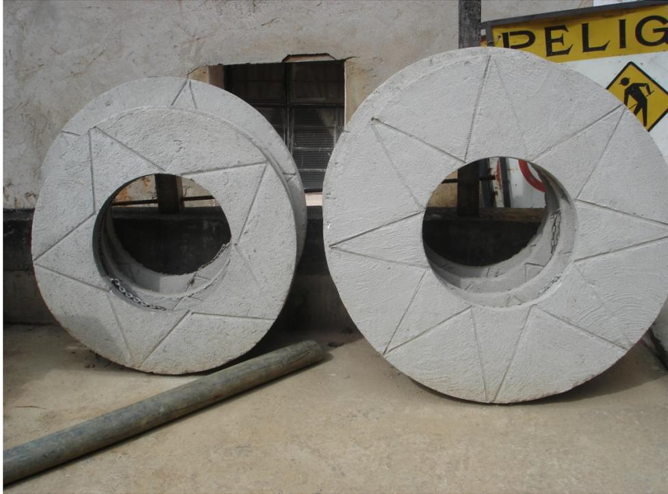
Ilustración 20 Prefabricados anillo del pozo
